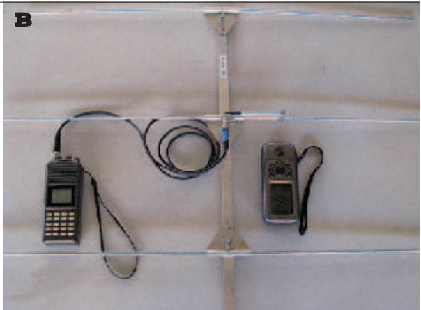
FIGURA 18. A. Colocación de un radiotransmisor en una rata negra, Isla Isabel, Golfo de California, México. B. Equipamiento utilizado en radiotelemetría: antena, receptor y GPS.
